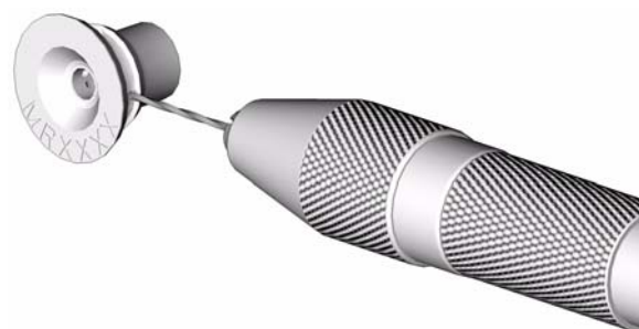
Рис. 1. Прочистка отверстий для компонента А (изоцианат)
