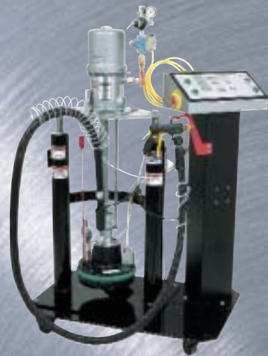
Therm-O-Flow® Plus Разгрузчик бестарного термоклея
